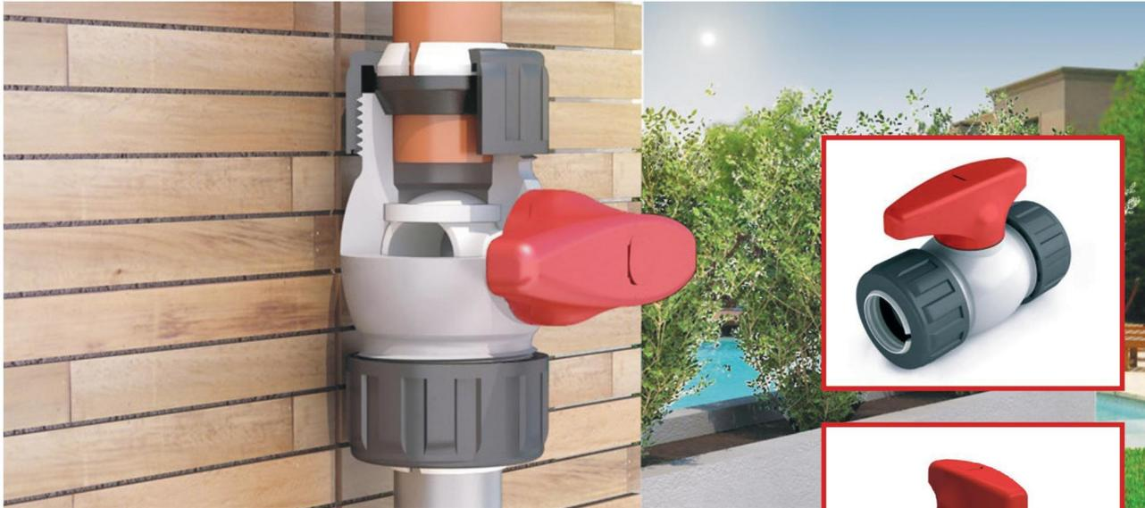
Válvula dos uniones con traba mecánica (Junta Dresser) para reparar o conectar en forma rápida y sencilla todo tipo de caños, ya sean plásticos o de otros materiales. Cuerpo: PP Conexión: 1/2" a 3/4" pulgadas Sello: Termoplástico Apto Agua Fría y Caliente 80<sup>a</sup>
